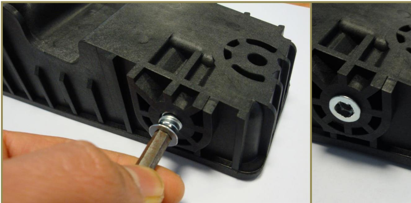
1. INSERIRE I DUE INSERTI AUTOFILETTANTI NELLE SEDI SULLA VASCA SUPERIORE.
