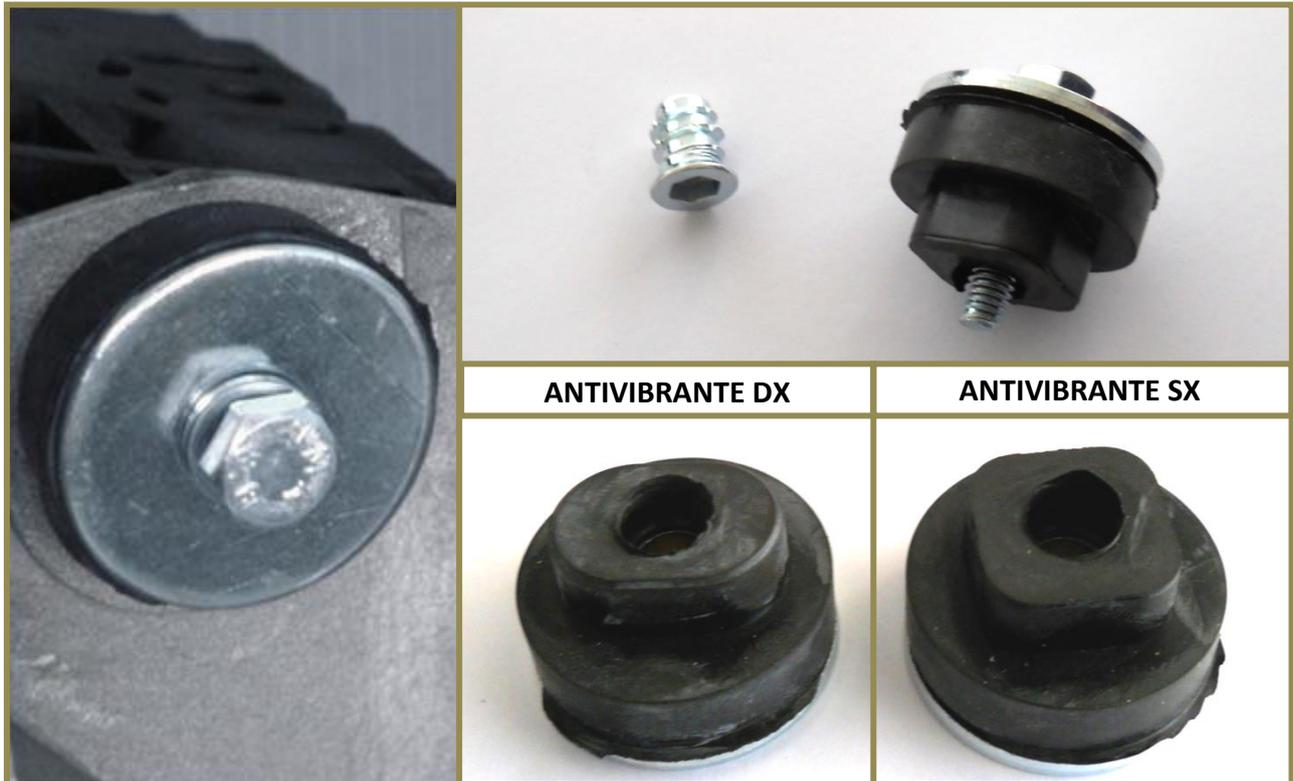
**IMPORTANTE:** INSERIRE L'ANTIVIBRANTE NELLA SEDE PREPOSTA SULLE FUSIONI IN ALLUMINIO! ESSO CONSENTE DI AMMORTIZZARE LO SPOSTAMENTO TRA IL RADIATORE ACQUA E L'INTERCOOLER DOVUTO ALLA DIFFERENTE ESPANSIONE TERMICA DEI DUE RADIATORI. CIO' EVITA CHE L'INTERCOOLER POSSA STRAPPARE I TUBI DELL'ACQUA SOTTO IL COLLETTORE.
