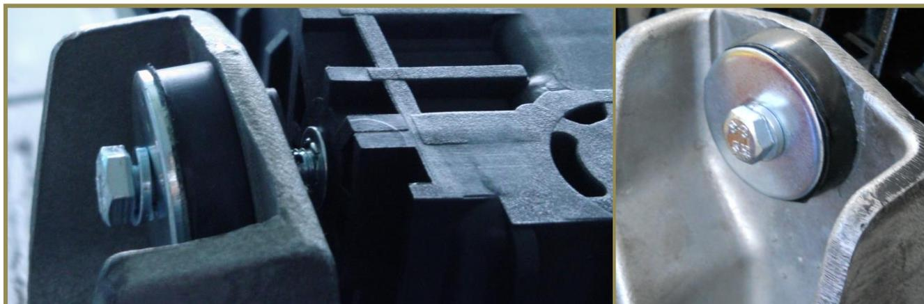
2. INSERIRE L'ANTIVIBRANTE NELLA SEDE SULLE FUSIONI IN ALLUMINIO (DISCRIMINANDO DESTRO E SINISTRO IN FUNZIONE DELLA FORMA) E IN SEGUITO SERRARE LA VITE.
